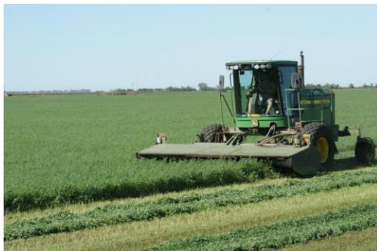
5. Mantenga las cuchillas bien afiladas. Permitirá realizar cortes netos sin desgarros, mejorar el rebrote, disminuir la pérdida de hojas y reducir el requerimiento de potencia de la maquinaria.
